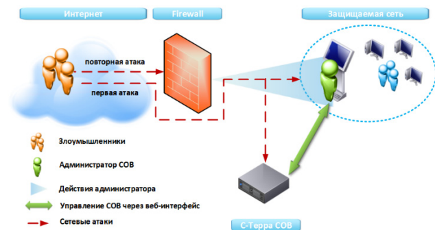
Рисунок 11 - Механизм работы Системы Обнаружения Вторжений
