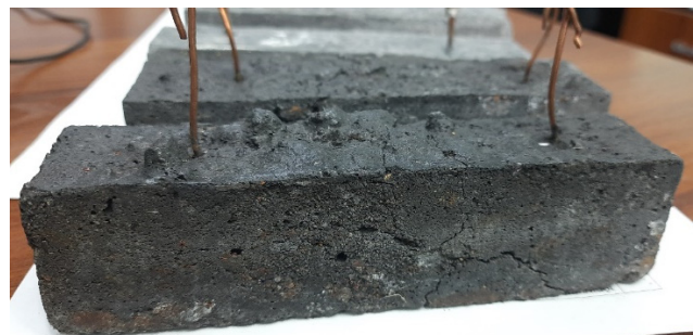
Рисунок 3 – Электропроводящий бетон образец № 3-4 с быстрым подогревом до 100 °С.
